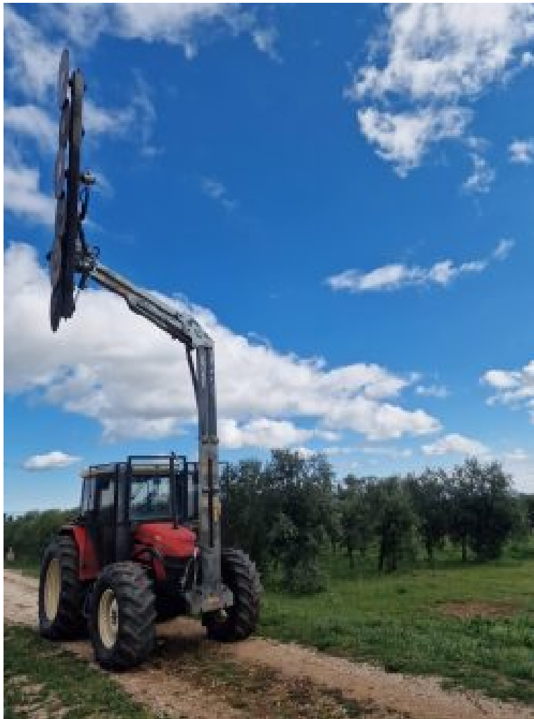
Foto 1- Trattore con barra falciatrice a dischi per topping e hedging
