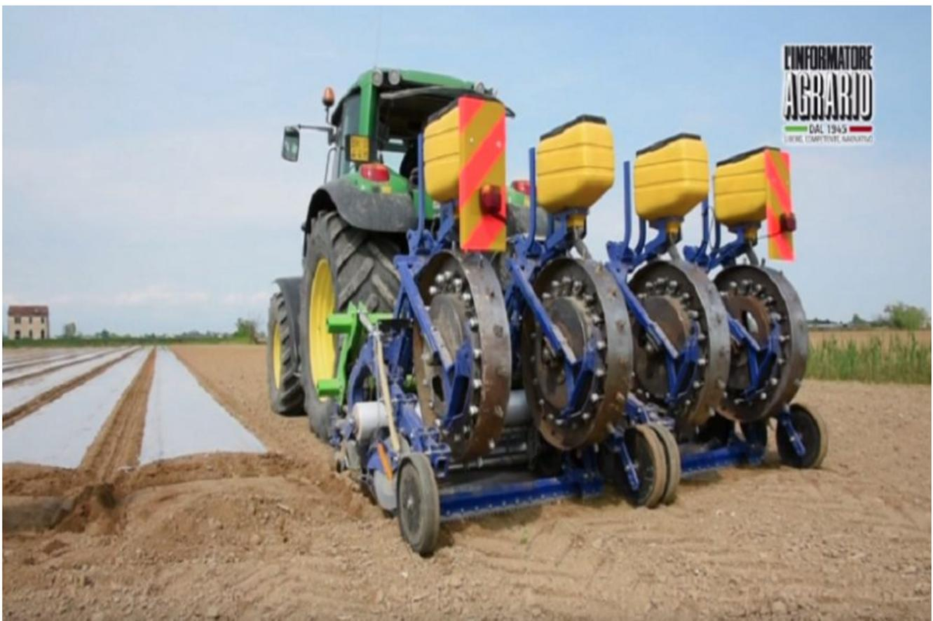
Il prototipo di pacciaseminatrice testato presso l'Azienda agricola Stoppato a Gazzo Veronese (Verona) stende un film pacciamante biodegradabile e, contemporaneamente, inietta un fertilizzante liquido e semina il mais bucando, con un apposito apparato, il film.
