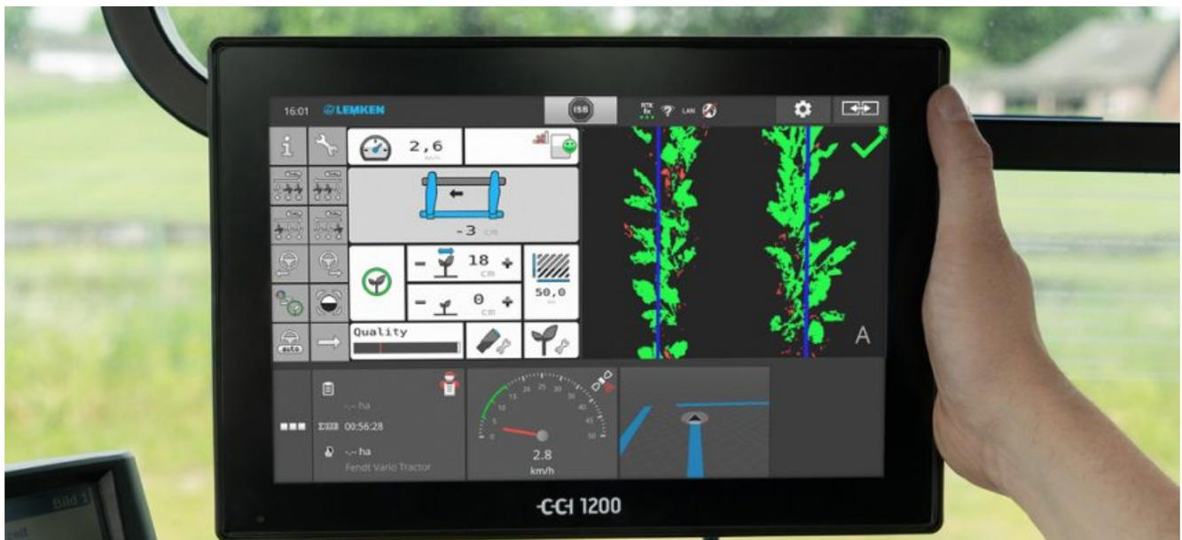
In passato gli agricoltori avevano bisogno di due terminali per utilizzare una **sarchiatrice con telecamera e controllo delle sezioni**: il terminale Isobus per il controllo della larghezza di lavoro e un secondo terminale per visualizzare l'immagine della telecamera e regolare l'organo lavorante.
