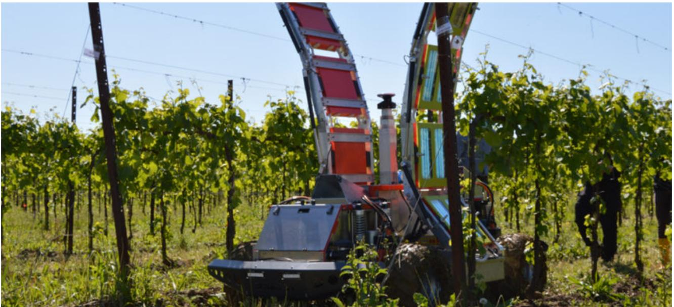
Dopo oltre quattro anni di intenso lavoro, è partita oggi la sperimentazione in vigneto di Icaro X4, il robot sostenibile che sfrutta i **raggi ultravioletti (UV)** per combattere i parassiti della vite.
