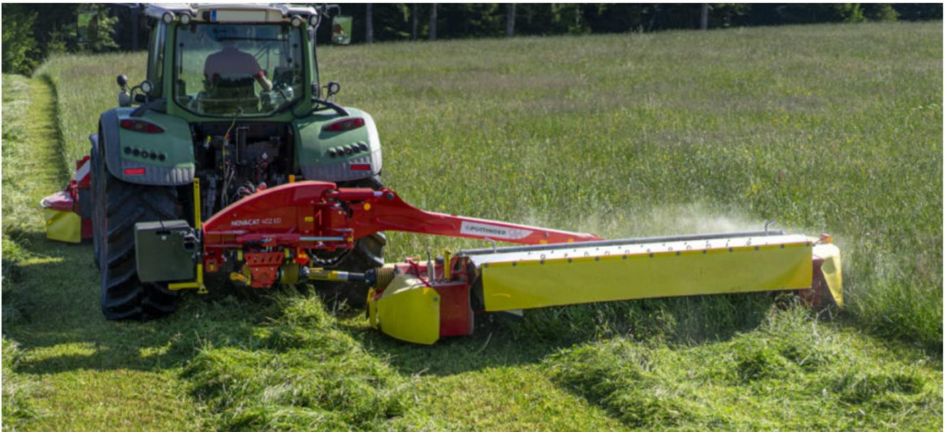
**Pöttinger** ha ampliato la sua offerta di falciatrici con il **modello laterale Novacat 402 ED** con larghezza di lavoro di 3,88 m. Nella Novacat 402 ED il **condizionatore ED (extra dry)** con rotore a denti garantisce un deposito del foraggio in andana soffice e uniforme.
