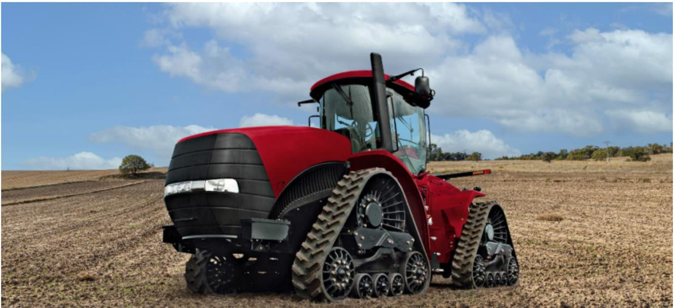
Al recente Sima di Parigi BKT ha presentato una novità assoluta: **Agriforce BK T71**, la **nuovissima serie di cingoli in gomma destinata all'agricoltura e in particolare ai trattori di elevata potenza** utilizzati per la lavorazione del terreno e per le colture in filari.
