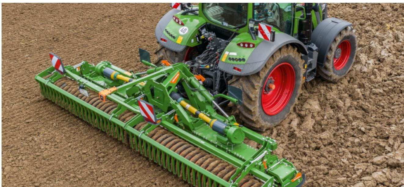
Amazone ha ampliato la sua gamma di nuovi erpici rotanti KE 02 Rotamix con l'aggiunta di una variante **pieghevole da 6 metri**. Il KE 6002-2 400 Rotamix è omologato per trattori con **potenze fino a 400 CV** e si caratterizza, in particolare, per la sua elevata potenza e per la notevole capacità di **frantumazione** e quindi di formazione di terreno fine.
