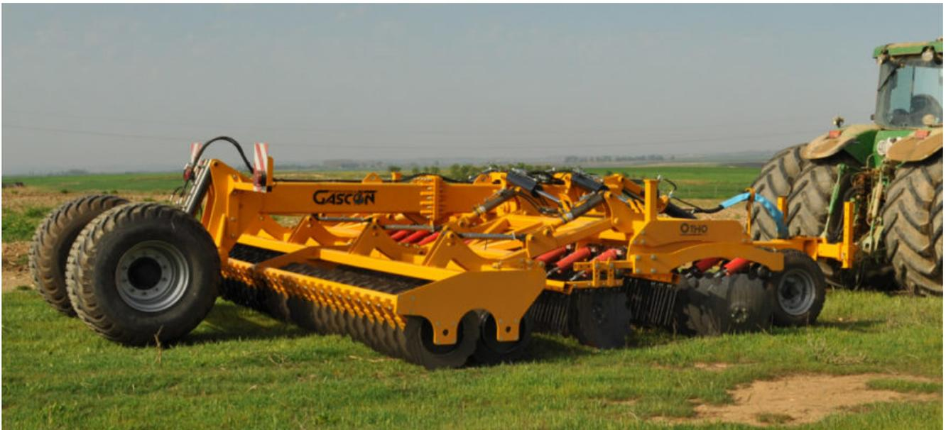
**Gascón**, azienda spagnola produttrice di macchine agricole, propone una **nuova serie di erpici a dischi** altamente performanti e con grande capacità di triturazione e interrimento delle stoppie. La particolare struttura costruttiva consente un **ottimale livellamento del suolo**, creando uno strato di terreno uniforme con un'unica passata, particolarmente **adatto a semine superficiali o con semi di piccole dimensioni**.
