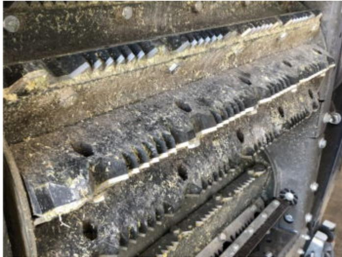
I rulli di alimentazione sono gli stessi di quelli montati sulle trince della serie precedente ma le lame sono state rivestite di uno spesso strato di materiale plastico che ha la funzione di lavorare delicatamente il prodotto in ingresso
