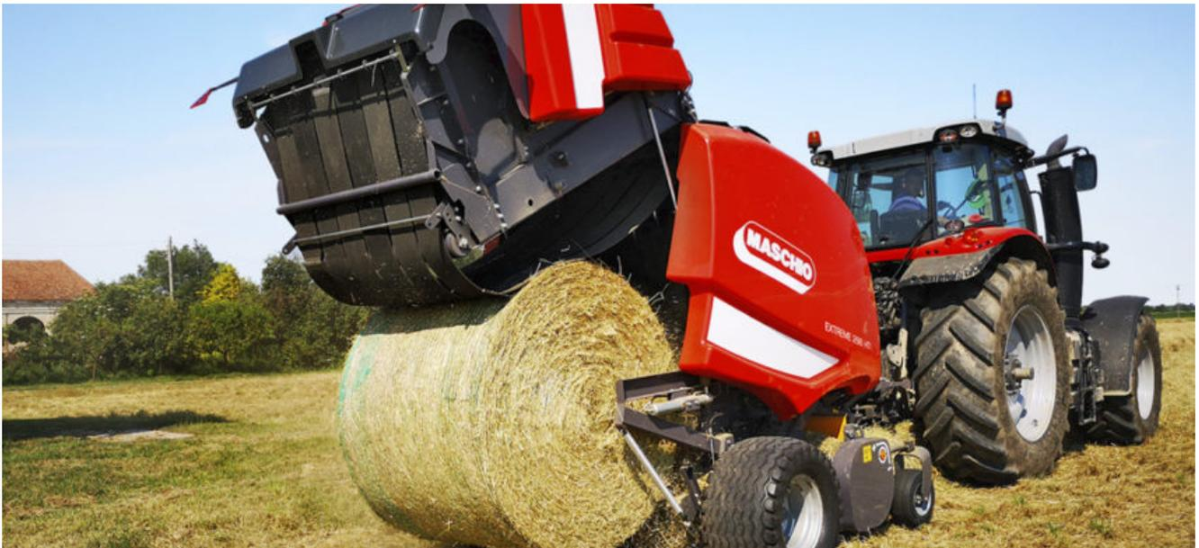
**Extreme 266**, parte della Serie 2 di casa **Maschio Gaspardo**, è la nuova **rotopressa ibrida a geometria e camera variabile**, che riassume perfettamente le caratteristiche vincenti delle rotopresse a camera fissa e variabile.
