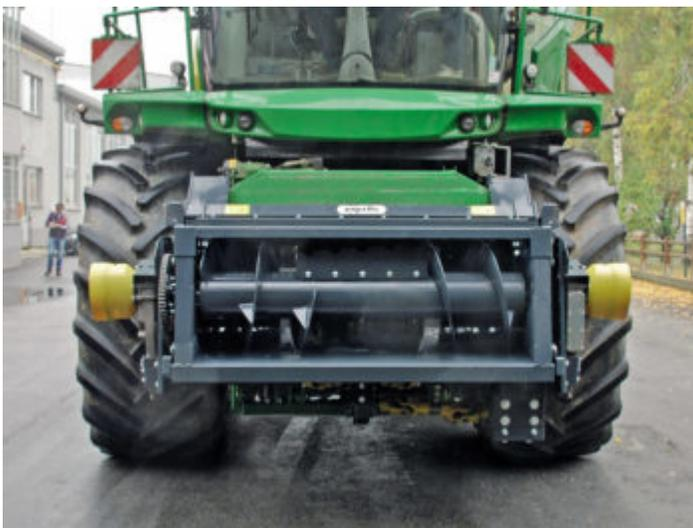
Quick up permette di collegare la testata mais Capello usata sulla mietitrebbia a una trincia semovente
