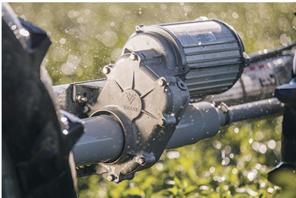
Il motore a corrente continua del nuovo sistema di avanzamento per i pivot Valley® X-Tec®
