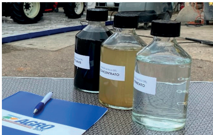
Foto 4 Risultato del processo con Agrobox: da sinistra la soluzione raccolta a fine lavaggio, in centro il concentrato, a destra il permeato. Dalle analisi dei residui è risultato che nel permeato i prodotti fitosanitari e i metalli pesanti sono presenti in quantità inferiori ai limiti di quantificazione (LOQ 0,01 ppm)
