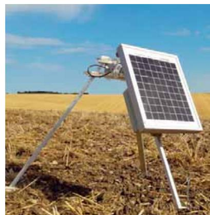
di scegliere l'opzione di copertura più adatta ai territori agricoli. Questo dispositivo elettronico, autonomo dal punto di vista energetico grazie alla batteria e al pannello solare, è montato su un supporto fisso che consente una facile installazione nei terreni da monitorare. Il dispositivo funziona con un basso tasso di errore (circa il 5%), senza l'intervento dell'utente, e permette il riconoscimento e l'i-
