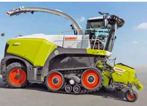
dei cingoli durante le svolte a fondo campo, per effetto della spinta verso il basso ricevuta dai rulli d'appoggio di ogni cingolo a opera di cilindri idraulici, mentre il rullo anteriore di trazione viene sollevato e la superficie di contatto ridotta di
