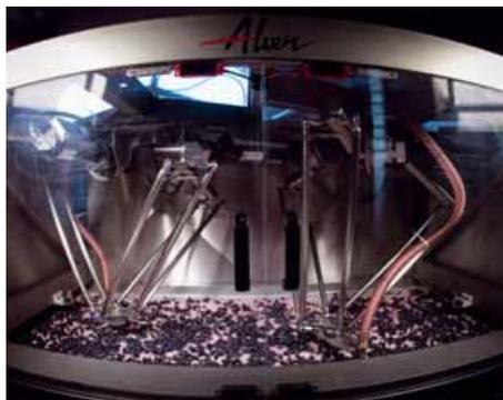
Il sistema è in grado di analizzare fino a 8 tonnellate di uva in un'ora e intercettare 400 elementi ritenuti negativi per minuto.
