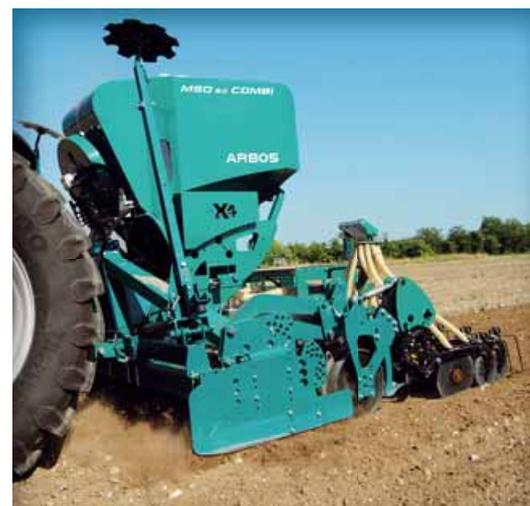
Seminatrice combinata MSD 2.0 Combi: i rotori esercitano sul terreno lavorato un'energica azione di disturbo lungo i primi 10-32 cm del profilo, con il rullo che ricompatta in maniera significativa il terreno smosso prima del passaggio degli elementi di semina
