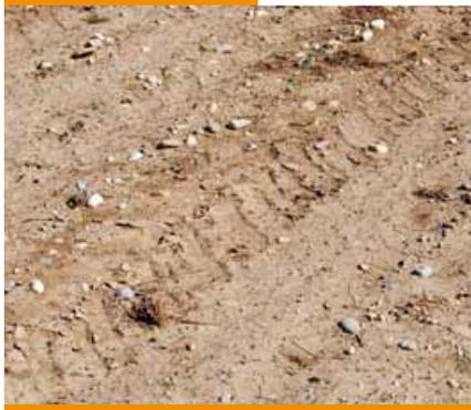
**Facili.** La prova si è svolta su un appezzamento pianeggiante, con terreno leggero (sabbia 63%; limo 23%; argilla 14%) ricco in scheletro di dimensioni molto eterogenee (media:  $7,4 \pm 4,3$  cm), privo di residuo colturale e precedentemente lavorato superficialmente. Il terreno si presentava con un tenore di umidità medio-basso in corrispondenza dei primi 10 cm.
