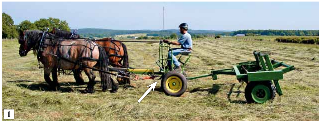
All'avantreno o portattrezzi (indicato dalla freccia) possono essere collegate diverse attrezzature, come per esempio il voltafieno a destra nella foto
