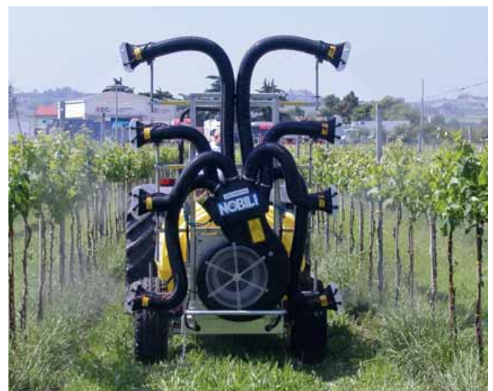
Foto 2 - Le irroratrici con diffusori multipli alimentati mediante tubi flessibili consentono di avvicinare i getti alla vegetazione
