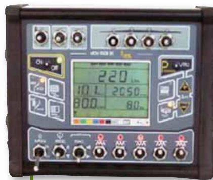
Foto 4 - Il computer di bordo permette un controllo ottimale sulla distribuzione
