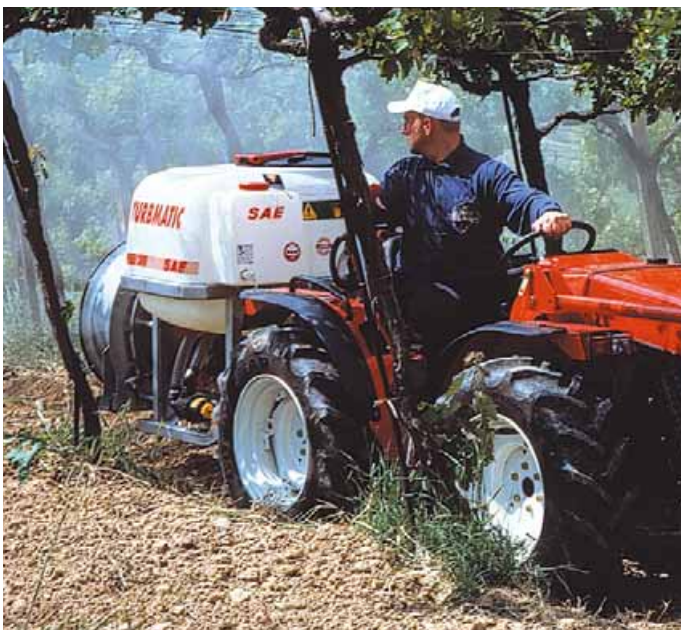
Foto 1 - Il tradizionale atomizzatore a ventilatore assiale spesso è insostituibile per i trattamenti di vigneti inaccessibili alle macchine più specializzate, come nel caso delle pergole e dei tendoni. In questi casi occorre mantenerlo in perfetta efficienza ed effettuare accurate e frequenti tarature
