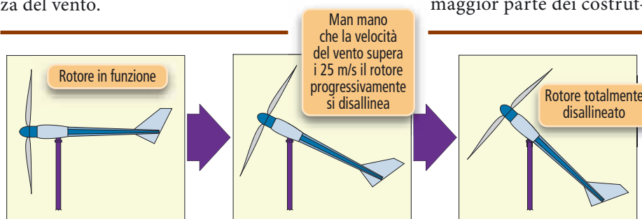
FIGURA 2 - Fasi del disallineamento del rotore
