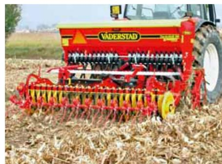
tipo packer, con elementi a profilo ondulato, posizionato posteriormente agli elementi di semina, avente diametro pari a 600 mm e sistema di regolazione idraulica centralizzato. Posteriormente è collocato un erpice a denti elastici per la miscelazione del terreno smosso con il residuo culturale;
