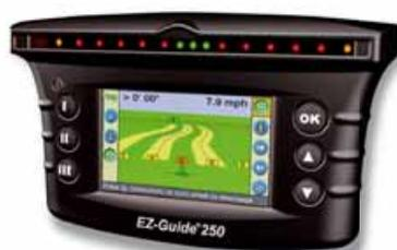
po, numero passata, passate già eseguite, scostamento dalla traiettoria teorica, velocità di avanzamento, ettari lavorati, campi presenti in memoria al passaggio nelle vicinanze. Tali dati possono essere trasferiti mediante dispositivo Usb.
