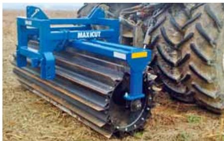
Trinciastocchi portato a utensili passivi, con larghezza pari a 3 m. È costituito da un telaio fisso, sul quale è inserito un rullo cavo, che può essere riempito d'acqua per aumentare il peso scaricato a terra e l'impatto sul residuo, con diametro pari a 710 mm, sulla cui superficie sono flangiate delle lame a margine liscio e profilo a «L» ricurva.
