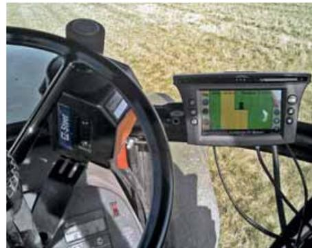
Attuatore elettrico ad azione meccanica da applicare a lato del volante, per sostituire l'intervento manuale dell'operatore nella correzione della traiettoria con un intervento automatico di tipo assistito. È compatibile con i sistemi di ausilio alla guida EZ-Guide 250, EZ-Guide 500 e Autopilot.
