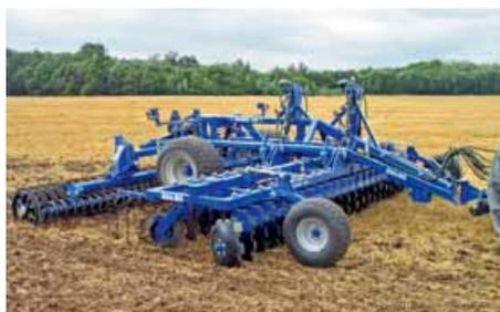
Macchina semiportata, con larghezza di 6 m. È indicata per la preparazione e la minima lavorazione (profondità massima: 15 cm), con telaio modulare a ripiegamento idraulico e carrello di trasporto, sul quale sono inseriti gli organi di lavoro.
