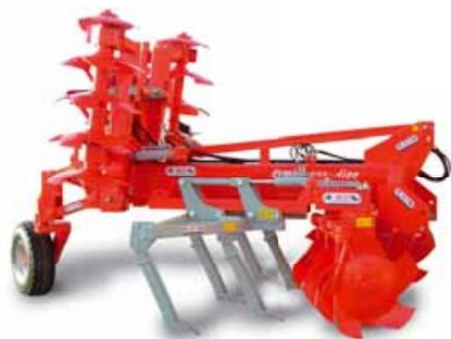
Attrezzatura portata, con larghezza di 3,15 m indicata per la fessurazione dello strato più profondo di terreno (profondità massima: 55 cm), senza la sua inversione, e il rimescolamento dello strato superficiale (profondità massima: 30 cm), con telaio a struttura fissa, sul quale sono inseriti una ruota posteriore d'appoggio per il trasporto e nella parte centrale gli organi di lavoro.
