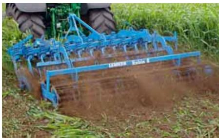
Coltivatore a dischi portato, con larghezza di 3 m, indicato per la lavorazione delle stoppie e la miscelazione del residuo nello strato più superficiale del terreno smosso (profondità massima 12 cm), con telaio fisso, sul quale sono inseriti gli organi di lavoro.
