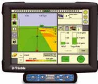
Sistema di bordo modulare che integra un sistema di ausilio alla guida di diversa tipologia, con interfaccia di collegamento seriale ai controller per la gestione delle attrezzature e la distribuzione a dose-volume variabile, con la possibilità di trasferimento tra diverse trattrici per qualsiasi operazione agronomica.
