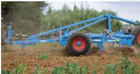
**Utensili per l'affinamento della zollosità:** doppio rullo a gabbia con diametro di 540 o 600 mm, con regolazione idraulica centralizzata.
