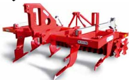
Dissodatore portato con larghezza di 3 m indicato per la decompattazione dello strato più profondo (profondità massima: 50 cm) e la lavorazione dello strato superficiale (profondità massima: 20 cm) del terreno, con telaio a struttura fissa sul quale sono inseriti gli organi di lavoro.
