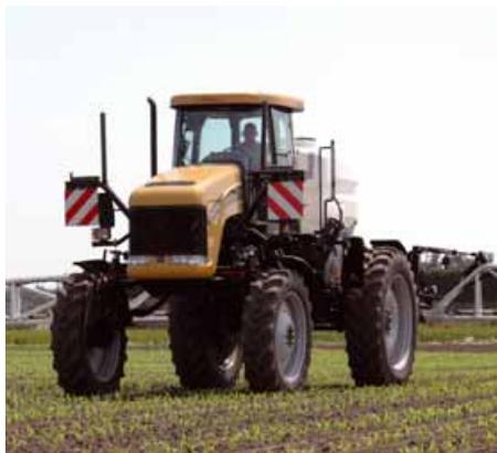
suddivisa in sezioni (da 5 a 11) con spaziatura degli ugelli pari a 50 cm, presenta una larghezza pari a 24 m ed è accoppiata al telaio mediante supporto a trapezio con sistema di ammortizzazione idraulica e sostegno di ogni sezione di barra mediante accumulatori di azoto.
