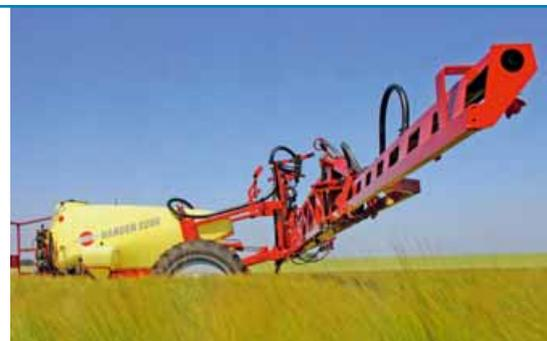
con ammortizzazione delle oscillazioni mediante molle in acciaio e appositi stabilizzatori.
