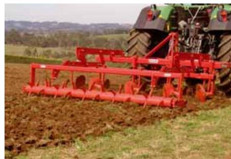
**Utensili per l'affinamento della zollosità:** rullo a gabbia con diametro di 550 mm con regolazione meccanica manuale della posizione, mediante perni su ghiera forata, cui si può aggiungere (a richiesta) un erpice a denti elastici, da collocare tra i dischi e il rullo in posizione registrabile.
