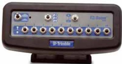
Sistema per il controllo automatico delle distinte sezioni (fino a un massimo di 10) della barra di distribuzione sulla base del dato di posizione, utilizzato dal sistema di gestione collegato per la gestione delle elettrovalvole poste a chiusura-apertura dei gruppi di ugelli, al fine di evitare le sovrapposizioni.
