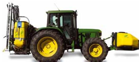
tato, è suddivisa in 5 sezioni, presenta una larghezza pari a 15 m ed è accoppiata al telaio mediante supporto a regolazione idraulica, con sistema a trapezio dotato di bielle e ammortizzazione delle oscillazioni sul piano verticale mediante molle accoppiate a cavi in acciaio.
