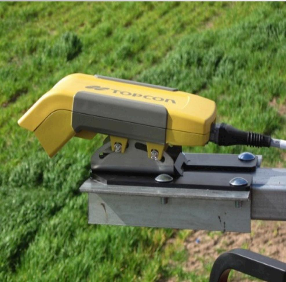
Fotosensore per la rilevazione delle onde elettromagnetiche riflesse dalla coltura
